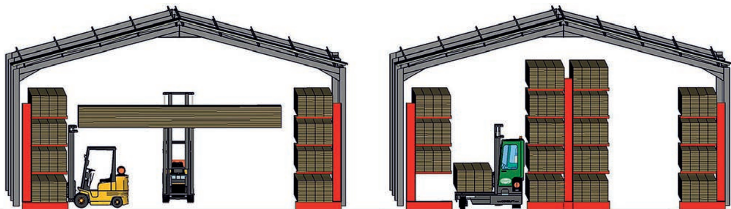
Comparaison entre un chariot élévateur ordinaire (à gauche) et un chargeur à prise latérale Combilift (à droite): le Combilift à conduite latérale se déplace sans problème à travers des allées plus étroites si bien qu'on peut stocker davantage sur une surface au sol plus petite
